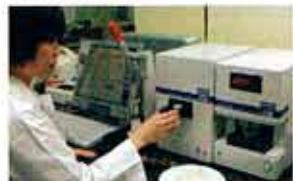
食味鑑定機器 米の新鮮度(香り)、炊飯米の食味(外観)、ご飯の硬さ・粘り(食感)を測定し、総合的に判定します。
